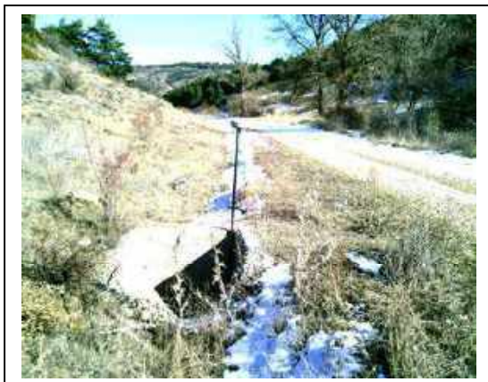
Foto situación base de replanteo
